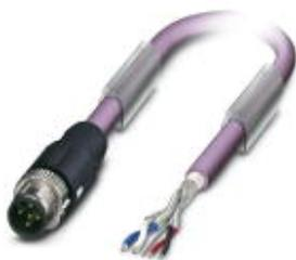
Системный кабель шины, CANopen®, DeviceNet™, 5-полюсн., PUR без галогенов, фиолетовый RAL 4001, экранирован., Штекеры прямое M12 SPEEDCON, A-кодирование, к свободный конец, длина кабеля: 10 м
