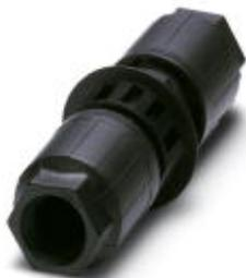
Кабельный соединитель, Тип подключения QUICKON, полюсов: 3+PE, 1 мм<sup>2</sup> ... 2,5 мм<sup>2</sup>, 690 В, 20 А, черный, с двумя гайками QUICKON, диапазон диаметра кабеля: 6 мм ... 10 мм, Устройство для быстрого подсоединения QUICKON
