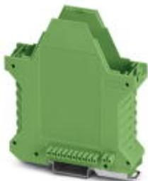
Установочный корпус, длина: 99 мм, без вентиляционных отверстий, Нижняя часть корпуса, поперечное соединение: встроенный шинный соединитель, цвет: зеленый, ширина: 22,5 мм, высота: 114,5 мм, кол-во контактов поперечного соединителя: 10+2
