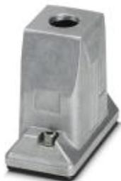
Сальниковый корпус HEAVYCON ADVANCE B10, с винтовым зажимом (внутренний шестигранник) из нержавеющей стали, стойкий к воздействию морской воды алюминий, высота 93,7 мм, с резьбой 1x M25, прямым кабельным отводом, без покрытия; проводящее уплотнение (свойства ЭМС)
