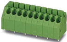
Клеммы для печатной платы, номинальный ток: 8 А, номинальное напряжение: 400 В, размер шага: 3,5 мм, полюсов: 10, тип подключения: Пружинные зажимы Push-in, монтаж: Пайка волной припоя, направление подключения, проводник/печатная плата: 45 °, цвет: зеленый. Смещенные выводы под пайку, двухрядн.
