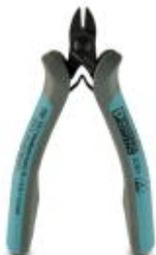
Бокорезы для электроники ESD, круглая головка, без фаски, с открывающей пружиной, с антибликовым покрытием и фосфатированные, двухкомп. рукоятка, режущая способность для материала: мягкий 0,2 ... 2,0 мм; средний 1 мм, упаковка: с держателем для демонстрационного стенда (Backcard)
