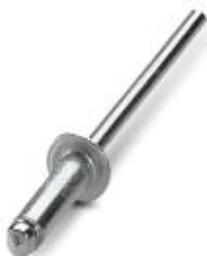
Закладная заклепка, Ø 3,2 мм, длина гильзы 12 мм, алюминиевая гильза, стальной оцинкованный пробойник, усеченная головка, стандартный вариант примерно как DIN 7337 A
