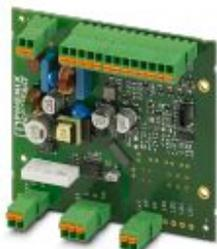
Устройство управления зарядкой EV-CC-AC1-M3-CC-SER-PCB-MSTB в виде печатной платы для зарядки электромобилей согласно МЭК 61851-1, режим 3, оптимально подходит для зарядных станций со стационарным зарядным штекером. Подключение посредством штекерного разъема для печатной платы на разъем на плату.
