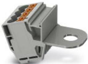
Клеммы-отводы, номинальное напряжение: 1000 В, номинальный ток: 41 А, тип подключения: Зажимы Push-in, Болтовые клеммы, количество точек подсоединения: 5, сечение: 0,5 мм<sup>2</sup> - 10 мм<sup>2</sup>, AWG: 20 - 8, ширина: 31 мм, высота: 32,3 мм, цвет: серый, тип монтажа: на основной элемент
