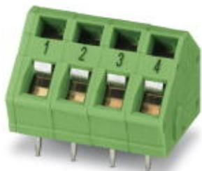
Клеммы для печатной платы, номинальный ток (Ex): 16 А, номинальное напряжение (Ex): 176 В, размер шага: 5 мм, полюсов: 4, тип подключения: Пружинный зажим, монтаж: Пайка волной припоя, направление подключения, проводник/печатная плата: 45°, цвет: зеленый. Клемма печатной платы соответствует требованиям «Директивы для PROFINET» в редакции от 05/2017
