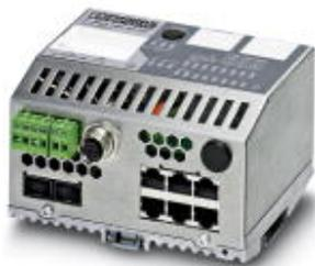
Интеллектуальный компактный управляемый коммутатор Ethernet с шестью портами RJ45 (10/100 Мбит/с) и двумя слотами SFP (1000 Мбит/с)
