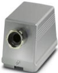
Корпус с кабельным сальником, крепление производится одной защелкой, высота 96 мм, с резьбовым соединением, 1x Pg36, подключение кабеля сбоку
