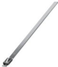
Кабельный зажим, из нержавеющей высококачественной стали (AISI 316), подходит и для агрессивных сред (напр., морская вода), с шариковым запором, для быстрого и надежного соединения и крепления
