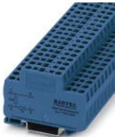
Клеммный блок, с сопротивлением 10 кОм для мониторинга обрыва провода, номинальное напряжение: 500 В, номинальный ток: 22 А, тип подключения: Пружинный зажим, сечение: 0,08 мм<sup>2</sup> - 4 мм<sup>2</sup>, AWG: 28 - 12, длина: 67,5 мм, ширина: 5,2 мм, цвет: синий, монтаж: NS 35/7,5, NS 35/15, номинальное напряжение: 500 В
