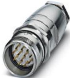
Переходные соединители, соединительная часть с резьбой Pg11, прямой, экранирован.: нет, Винтовой зажим, M23, Полосов: 12, тип контактов: Штифт, Подключение пайкой, диапазон диаметра кабеля: 8 мм ... 12 мм
