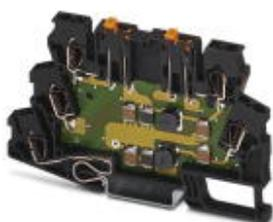
TERMITRAB, клеммный блок с пружинными зажимами, со встроенной защитой от перенапряжений в виде фильтра и разъединителей, для монтажа на NS 35/7.5, напряжение UN 24 В DC, ширина клеммного модуля: 6,2 мм, ширина крышки: 2,2 мм
