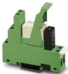
Релейный модуль с винтовыми зажимами в сборе, состоящий из установочного блока (основания), вставного миниатюрного реле контроля мощности с силовыми контактами, вставного индикатора, вставного подавителя помех и держателем реле. Входное напряжение: 24 В AC, контакты: 2 переключающих контакта, 8 А
