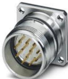
Приборный соединитель, передняя часть стенки, прямой, экранирован.: есть, Винтовой зажим, M23, Полюсов: 7, тип контактов: Штифт, Подключение пайкой, Плоское уплотнение, 4x Ø 3,2
