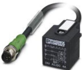
Кабель для датчика / исполнительного элемента, 3-полюсн., PUR без галогенов, темно-серый RAL 7021, Штекеры прямое M12 SPEEDCON, А-кодирование, к Штекер типа А для электромагнитного клапана, с 1 светодиодом, подключение с помощью Диод Зенера, длина кабеля: 1 м
