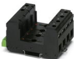
Базовый элемент для разрядников типа 2 серии VALVETRAB MS, с контактом для дистанционной передачи сигнала. Исполнение для 3-фазных цепей питания с отдельными проводниками N и PE.
