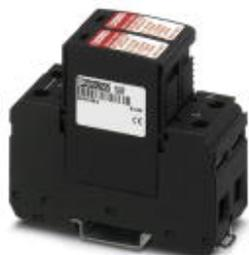
Универсальный вставной молниеотвод/разрядник для защиты от перенапряжений на базе варисторов для приложений -48 В пост. тока, в которых обратный провод (положительный полюс) заземлен, без оценки рисков для классов молниезащиты III и IV.
