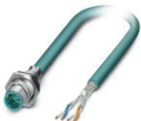
Встраиваемый разъем (вилка) шинной системы, Ethernet, 4-полюсный, M12-SPEEDCON, экранированный, с механическим ключом D-типа, монтаж с задней части стенки / резьбовое крепление M16, с кабелем шины длиной 0,5 м, 2 x 2 x 0,2 мм<sup>2</sup>
