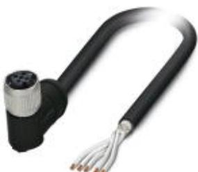
Кабель для датчика / исполнительного элемента, 5-полюсн., PE-X без галогенов, черный, экранирован., свободный конец, к Гнездо угловой M12 SPEEDCON, А-кодирование, длина кабеля: 5 м, для железнодорожного транспорта
