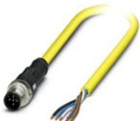
Кабель для датчика / исполнительного элемента, 5-полюсн., ПВХ, желтый, Штекеры прямое M12 SPEEDCON, A-кодирование, к свободный конец, длина кабеля: 10 м
