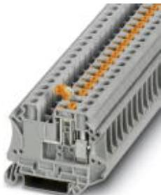
Клеммы с ножевыми размыкательями, номинальное напряжение: 500 В, номинальный ток: 20 А, тип подключения: Винтовые зажимы, сечение: 0,2 мм<sup>2</sup> - 10 мм<sup>2</sup>, AWG: 24 - 8, длина: 57,8 мм, ширина: 8,2 мм, цвет: синий, монтаж: NS 35/7,5, NS 35/15, номинальное напряжение: 500 В
