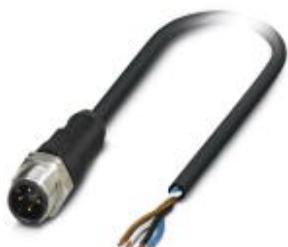
Кабель для датчика / исполнительного элемента, 4-полюсн., Специальный подбор материалов на базе ПВХ, черный RAL 9005, Штекеры прямое M12, А-кодирование, к свободный конец, длина кабеля: 3 м, для пищевой промышленности, с накатанной гайкой из легированной стали
