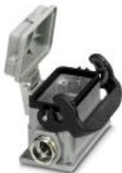
Приборный корпус с одной защелкой, высота 52 мм, с резьбовым соединением, 2x Pg16, с защитной крышкой
