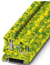
Клемма защитного провода, тип подключения: Винтовое / штекерное подключение, количество точек подсоединения: 2, сечение: 0,2 мм<sup>2</sup> - 10 мм<sup>2</sup>, AWG: 24 - 8, ширина: 8,2 мм, цвет: желто-зел., тип монтажа: NS 35/7,5, NS 35/15
