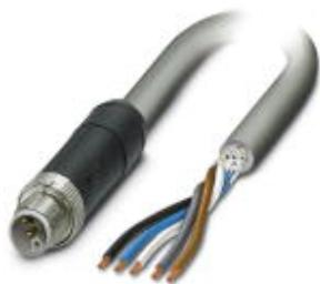
Силовой кабель, 5-полюсн., PUR без галогенов, серый RAL 7001, экранирован. (Advanced Shielding Technology), Штекеры прямое M12, L-кодирование, к свободный конец, длина кабеля: 3 м, для постоянного тока до 16 А / 63 В
