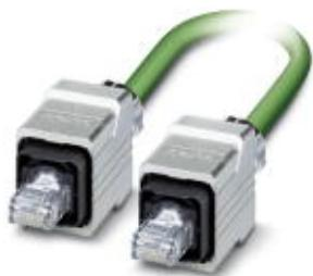
Готовый кабель PROFINET, CAT5e, экранированный, четверка звездообразной скрутки, AWG 22, гибкий (7-проводочный), RAL 6018 (желто-зеленый), с разъемом RJ45/IP67 Push-Pull, металлический корпус, на разъем RJ45/IP67 Push-Pull, металлический корпус, прямая разводка, длина: 5 м
