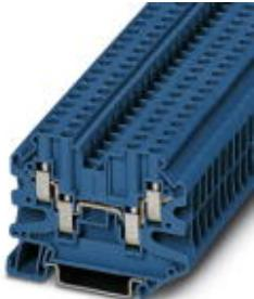
Четырехвыводные универсальные клеммы, номинальное напряжение: 1000 В, номинальный ток: 32 А, тип подключения: Винтовые зажимы, количество точек подсоединения: 4, сечение: 0,14 мм<sup>2</sup> - 6 мм<sup>2</sup>, AWG: 26 - 10, ширина: 6,2 мм, цвет: синий, тип монтажа: NS 35/7,5, NS 35/15
