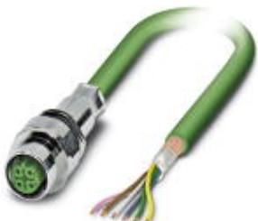
Встраиваемая розетка шинной системы, INTERBUS, 5-полюсная, M12, экранированная, с механическим ключом В-типа, монтаж с передней части стенки / резьбовое крепление с M16, позиционируемая, с кабелем шины длиной 5 м, 3 x 2 x 0,25 мм<sup>2</sup>
