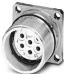
Приборный соединитель, передняя часть стенки, прямой, экранирован.: есть, для стандартной блокировки и SPEEDCON, M23, Полосов: 7, тип контактов: Розетка, Выводы под пайку, Плоское уплотнение, 4x Ø 3,2, размер фланца: 25 мм x 25 мм
