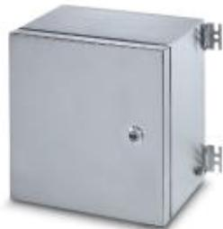
Клеммная коробка, материал: Высококачественная сталь 304 / 1.4301, поверхностное сопротивление: сатинированный, серебристый, 260 мм x 300 мм x 200 мм, тип замка: Дверь со сменным шарниром, комплект поставки - ATD: Монтажная плата, Крепежный кронштейн в комплекте с винтами, Штифты заземления M12, расположенные снаружи, Инструкция по монтажу, Монтажная плата
