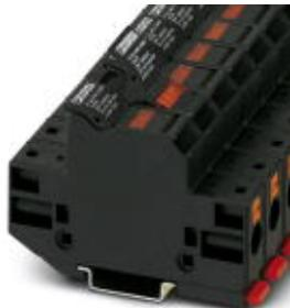
Клеммы для установки предохранителей, тип подключения: Зажимы Push-in, сечение: 1,5 мм<sup>2</sup>- 10 мм<sup>2</sup>, AWG: 16 - 6, номинальный ток: 20 A, номинальное напряжение: 1000 В, ширина: 17,6 мм, тип предохранителей: Миниатюрный / 10,3 x 38, тип монтажа: NS 35/7,5, NS 35/15, цвет: черный
