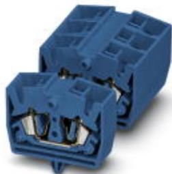
Проходная мини-клемма, номинальное напряжение: 800 В, номинальный ток: 24 А, тип подключения: Пружинный зажим, количество точек подсоединения: 4, сечение: 0,08 мм<sup>2</sup> - 4 мм<sup>2</sup>, AWG: 28 - 12, ширина: 10,4 мм, высота: 22 мм, цвет: синий, тип монтажа: на монтажную пластину
