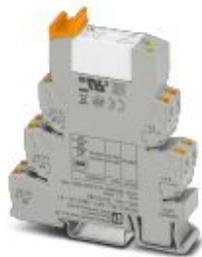
Интерфейсный блок PLC, состоит из базового клеммного модуля PLC-BPT.../21-21 с соединителем Push-in и вставным мини-реле с силовым контактом, установка на монтажную шину NS 35/7,5, 2 переключающих контакта, входное напряжение 48 В DC
