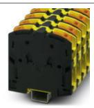
Клемма для высокого тока, номинальное напряжение: 1000 В AC / 1500 В DC, номинальный ток: 150 А, тип подключения: Зажим Power-Turn, количество точек подсоединения: 2, полюсов: 1, сечение: 10  $\,$  мм $^2$  - 70  $\,$  мм $^2$ , AWG: 8 - 2/0,  $\,$  ширина: 20  $\,$  мм, цвет: черный/желтый, тип монтажа: NS 35/15
