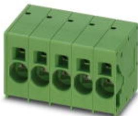
Клеммы для печатной платы, номинальный ток: 76 А, номинальное напряжение: 1000 В, размер шага: 10 мм, полюсов: 5, тип подключения: Пружинные зажимы Push-in, монтаж: Пайка волной припоя, направление подключения, проводник/печатная плата: 0 °, цвет: многоцветный
