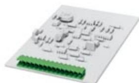
Корпусная часть для печатных плат, номинальный ток: 12 А, расчетное напряжение (III/2): 320 В, полюсов: 15, размер шага: 5 мм, цвет: зеленый, поверхность контакта: олово, монтаж: Пайка волной припоя
