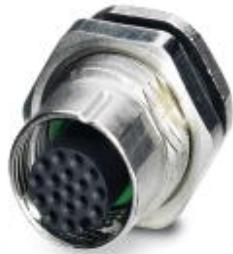
Встраиваемый разъем для датчика / исполнительного устройства, розеточная часть, 17-полюсный, M12-SPEEDCON, с механическим ключом А-типа, монтаж с задней части стенки / резьбовой монтаж с резьбой Pg9, с прямыми выводами под пайку
