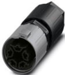
Разъем, Тип подключения QUICKON, полюсов: 4+PE, 2,5 мм<sup>2</sup> ... 6 мм<sup>2</sup>, 690 В, 40 А, черный, с гайкой QUICKON, диапазон диаметра кабеля: 9 мм ... 14 мм
