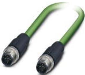
Сетевой кабель, PROFINET CAT5 (100 Мбит/с), EtherCAT® CAT5 (100 Мбит/с), 4-полюсн., PUR/FRNC без галогенов, зеленый RAL 6018, экранирован., Штекеры прямое M12 / IP67, механические ключи: D, к Штекеры прямое M12 / IP67, механические ключи: D, длина кабеля: 5 м
