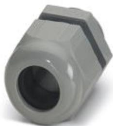
Кабельный ввод, материал резьбового соединения: PA, наружный диаметр кабеля 10 мм ... 14 мм, экранировка: нет, резьба соединительной части: NPT 1/2 дюйма., цвет: серебристо-серый RAL 7001
