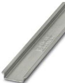
Несущая рейка без перфорации, Стандартный профиль, ширина: 35 мм, высота: 7,5 мм, согласно EN 60715, материал: Сталь, оцинкован., пассивирован., длина: 250 мм, цвет: серебристый
