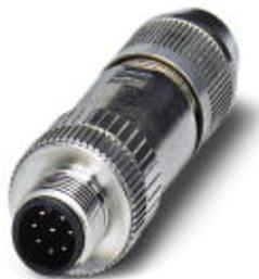
Шинный системный соединитель, Ethernet CAT5 (1 Гбит/с), 8-полюсн., экранирован., Штекеры прямое M12, A-кодирование, Клеммы с ножевыми контактами, материал накатанной гайки: Цинк. литья под давлением, с никелевым покрытием, наружный диаметр кабеля 4 мм ... 8 мм
