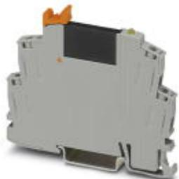
Смонтированный полупроводниковый релейный модуль с винтовым зажимом: цоколь реле с выбрасывателем и вставным миниатюрным полупроводниковым реле. Входное напряжение: 24 В пост. тока. Выход: 24-253 В перем. тока / 0,75 А
