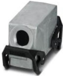
Сальниковый корпус B16, с двумя защелками, материал: Из алюминия, методом литья под давлением, стойкий к морской воде, длина кабеля: 1, боковое, высота: 60 мм, кабельный ввод: без, патрубок: Нет, 1x Pg16, Стандартн.
