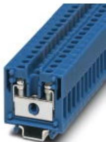
Проходная мини-клемма, номинальное напряжение: 500 В, номинальный ток: 24 А, тип подключения: Винтовые зажимы, количество точек подсоединения: 2, сечение: 0,2 мм<sup>2</sup> - 4 мм<sup>2</sup>, AWG: 24 - 12, ширина: 5,2 мм, цвет: синий, тип монтажа: NS 15
