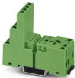
Установочный блок (основание) PR2-B для промышленных реле REL-IR с 2 или 4 переключающими контактами, 1/3-ярусное исполнение, винтовые зажимы, возможность установки вводных модулей и модулей подавления помех, монтируется на NS 35/7,5
